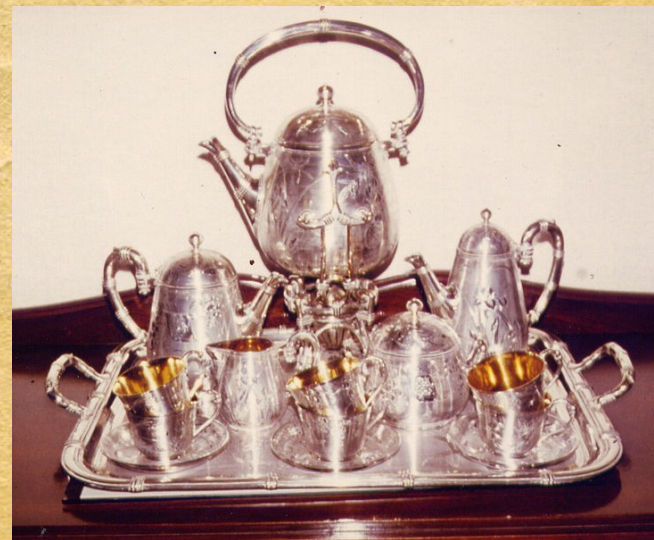
Гальванопластическое серебрение и золочение чайного сервиза
